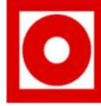
Pulsador de alarma
